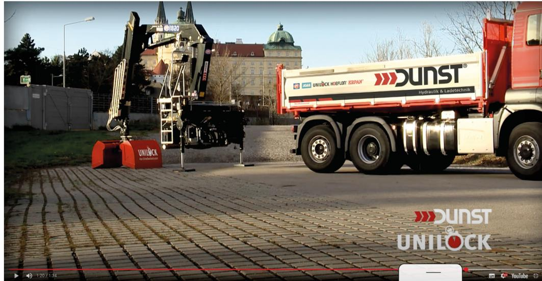
Bisher galt im Transportgewerbe, dass ein auf einem Lastwagen montierter Ladekran ausschließlich für dieses Fahrzeug nutzbar ist. Denn die Demontage und erneute Montage auf einen anderen LKW ist zeitaufwändig und somit kostspielig. Dieses revolutionäre patentierte System zur hydraulischen Abkopplung von LKW-Ladekränen spart Zeit und Kosten und sorgt für maximale Flexibilität im Einsatz.
