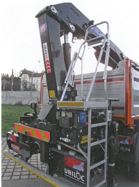
Detailansicht der patentierten Krankonsole Unilock und des HMF Kranes
