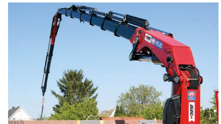
Der HMF 8520 erreicht bei 34 Metern Reichweite noch ein Hubgewicht von 1.700 kg.
