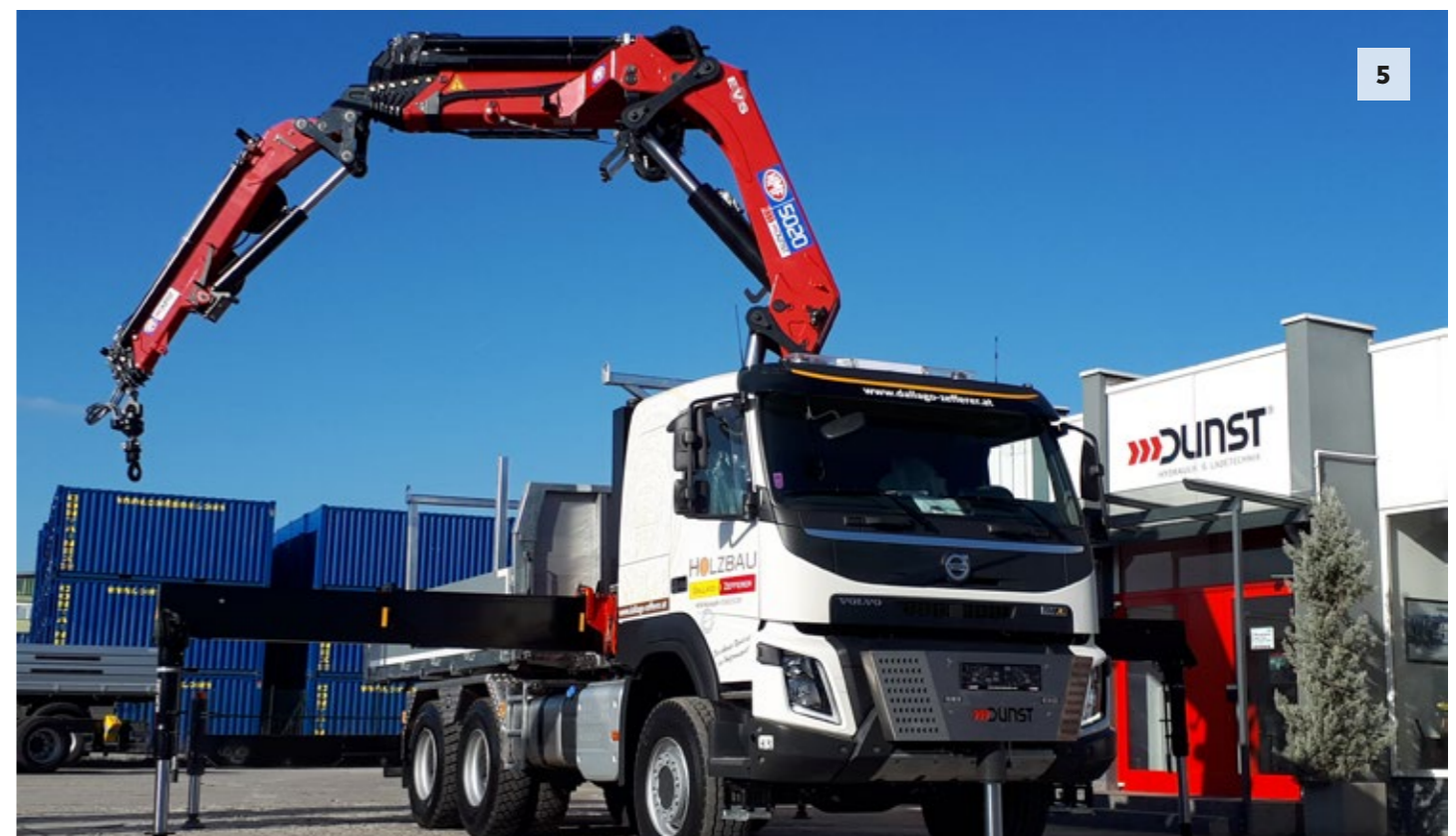
1. Als Sattelzugmaschine liefert der Neuzugang im Hause Dallago & Zefferer auch Fertigteilhäuser - für den großen HMF Kran keine Herausforderung. 2. Für einfaches Entladen ist die Wechselpritsche kippar ausgeführt. 3. Für maximale Flexibilität sorgt die per Kran oder Stapler abnehmbare Spezialpritsche. 4. Der Aufbau des HMF 5020-K6 + FJ 1000-K4 und der Wechselpritsche erfolgte bei Dunst Hydraulik & Ladetechnik am Standort Lieboch. 5. Zusätzlich zu den Stützen sorgt das Standsicherheitsystem EVS für sicheres Be- und Entladen.
