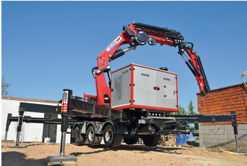
Autonom betriebener Anhänger mit 6-facher Abstützung und hydraulischer Zwangslenkung
