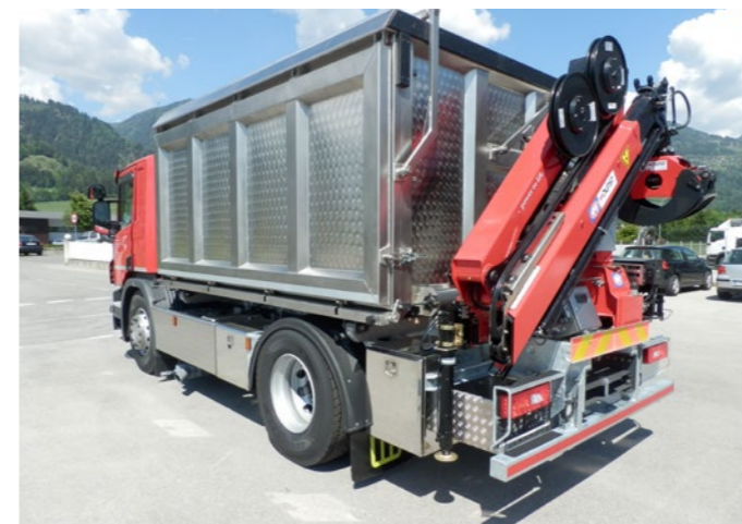
Die Premiere: Dieser HMF 810-K2 für die Steirische Tierkörperverwertung ist mit einer Funk-Waage ausgestattet und kann mitsamt dem Greifer zusammengelegt werden. Die Spezialität daran ist die von Dunst neu entwickelte Greiferaufhängung.
