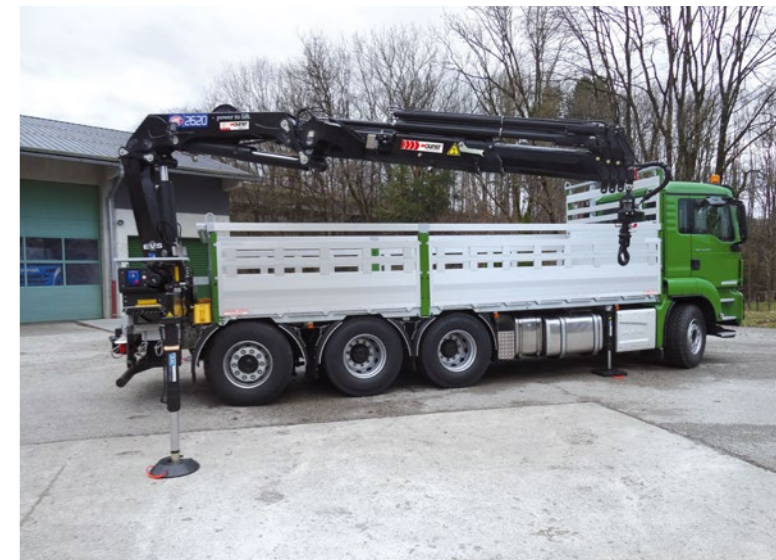
In der Wintersportregion Radstadt ist bei Sepp Harmil ein HMF 2620-K5 Ladekran auf einem wendigen Tridem Fahrgestell im Einsatz.
