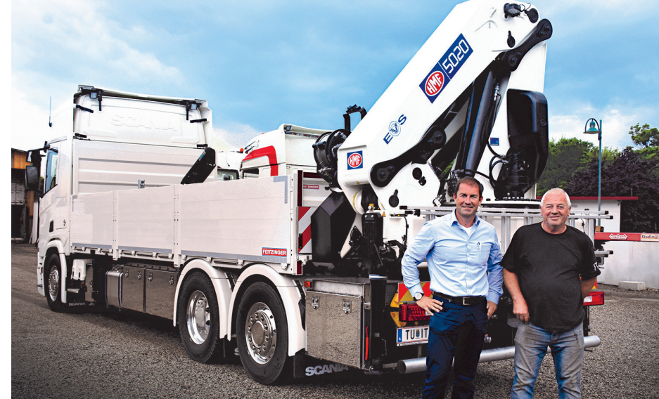
Auf einem klassischen Dreiaxser aufgebaut folgt bereits im Juni 2018 mit einem HMF 5020-K5 + FJ1000-K4 der zweite dänische Kran mit EVS Standsicherheitssystem.
